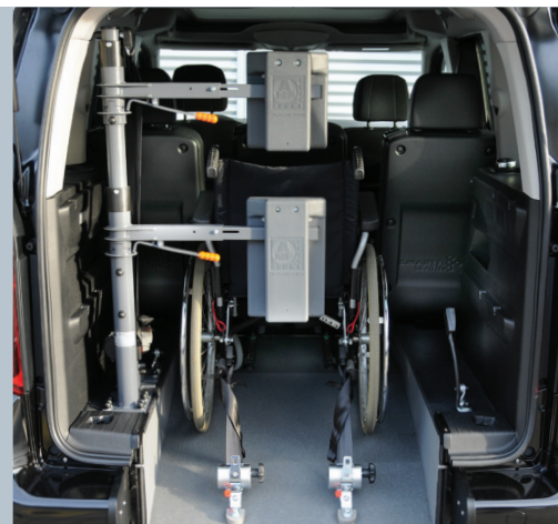
Das Fahrzeug kann mit der Kopf- und Rückenstütze FUTURESAFE ausgestattet werden.
